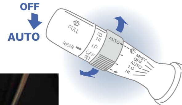
レバーを1段押し下げる(オート(AUTO)位置)、雨滴量に応じてワイパーが作動。また、レバー中ほどにあるリングで雨滴量に反応するセンサーの感度の高/低を調節できます。
